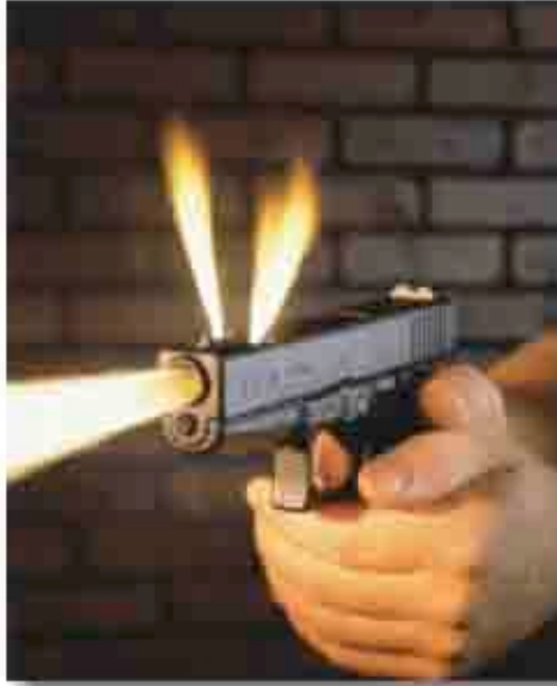
Der Rückstoßkompensator einer Glock in Aktion
